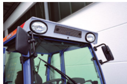
Tetőbe integrált kiegészítő munkafényezőrók biztosítják a munkaterület optimális megvilágítását. Pollenszűrő gondoskodik a fülke tiszta levegőjéről.
