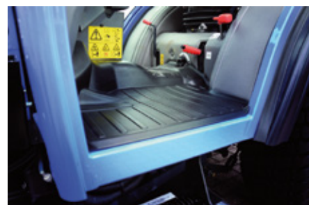
A fülke alját borító gumiszőnyeg szigetel a zaj és a hideg ellen, és gondoskodik - elsősorban a téli munkavégzéseknél - a víz irányított kivezetéséről, csökkentve ezáltal a korrózió esélyét.
