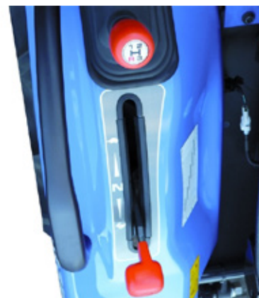
Erőteljes mechanikus váltómű 6 előre- és 2 hátrameneti fokozattal
