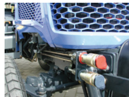
Az ISEKI traktoroknál alapfelszereltség a szivárgásmentes acél hidraulikavezeték, amely ipari körülmények között is biztosítja a biztonságos üzemelést.
