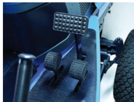
Az előre- és hátramenet kuplungolás nélkül a két ergonomikusan lekerített pedállal fokozatmentesen vezérelhető.
